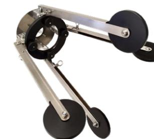
Zubehörteil für die Zentrierung des Proair-Bürstengeräts. Ermöglicht die Zentrierung der Bürste im Kanal, wodurch ein gleichmäßiger Druck über den gesamten Durchmesser des Kanals ausgeübt wird und Unwuchten vermieden werden. Die Räder ermöglichen eine einfache Schlauchführung und erleichtern dem Bediener die Handhabung des Schlauchs. Empfohlen für Kanäle ab Ø400 mm
