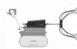
**MULTIBOT.** Multifunktionaler Roboter zur Reinigung, Inspektion und Beschichtung von Lüftungskanälen.
