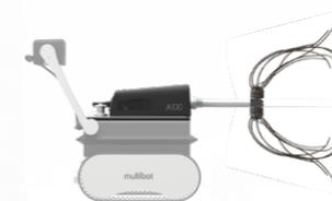
**MULTIBOT.** Multifunktionaler Roboter zur Reinigung, Inspektion und Beschichtung von Lüftungskanälen.
