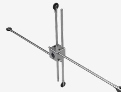
Accesorio para el centrado del cepillo Rotair. Permite centrar el cepillo en el conducto y con ello ejercer presión por igual en todo el diámetro del mismo evitando bandazos. Al tener ruedas permite un mejor deslizamiento y facilita el manejo de la manguera por parte del operario. Recomendado para conductos a partir de Ø400 mm
