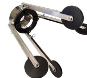
Accesorio para el centrado del cepillo Proair. Permite centrar el cepillo en el conducto y con ello ejercer presión por igual en todo el diámetro del mismo evitando bandazos. Al tener ruedas permite un mejor deslizamiento y facilita el manejo de la manguera por parte del operario. Recomendado para conductos a partir de Ø400 mm
