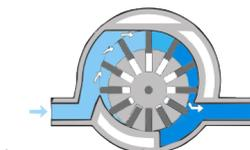
Système breveté d'« ailettes » coulissantes qui permet d'obtenir un volume important et une pression d'air élevée. Grâce au refroidissement automatique vous pouvez travailler 24 heures d'affilée.
