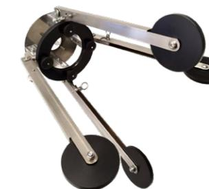
Accessoire permettant de centrer la brosse rotative. Permet de fixer et de centrer la brosse à l'intérieur du conduit pour couvrir uniformément tout son diamètre. Comme il est équipé de roues, il permet un meilleur glissement et facilite la manipulation du tuyau par l'opérateur. Valable pour les gaines à partir de Ø400 mm
