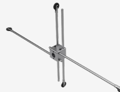
Accessoire permettant de centrer la brosse rotative. Permet de fixer et de centrer la brosse à l'intérieur du conduit pour couvrir uniformément tout son diamètre. Comme il est équipé de roues, il permet un meilleur glissement et facilite la manipulation du tuyau par l'opérateur. Valable pour les gaines à partir de Ø400 mm
